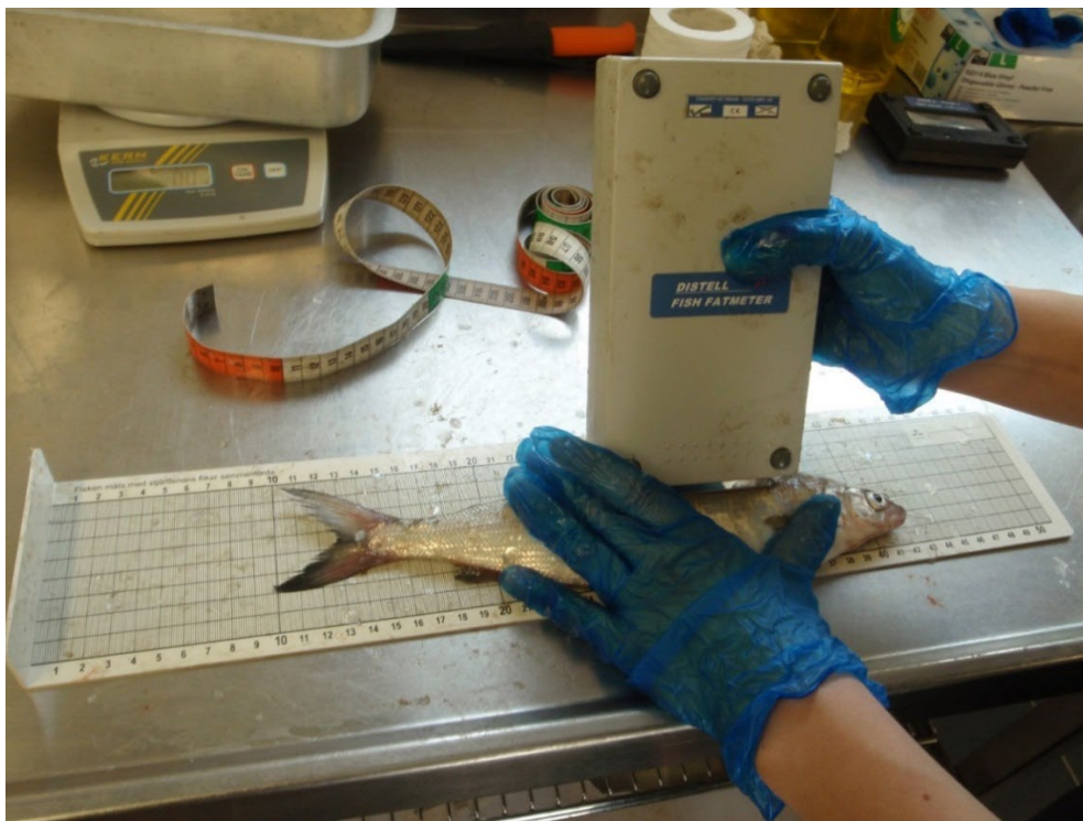
Figur 44. Fetthaltsmätning av sik med handhållen mätare.
